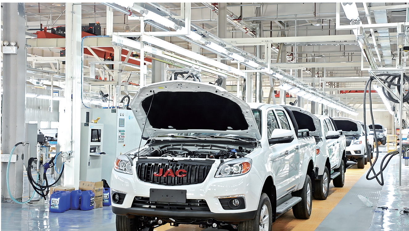
商用车完成组装，等待试压和测试。
