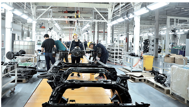
5月14日，工人在总装车间组装汽车底盘。
