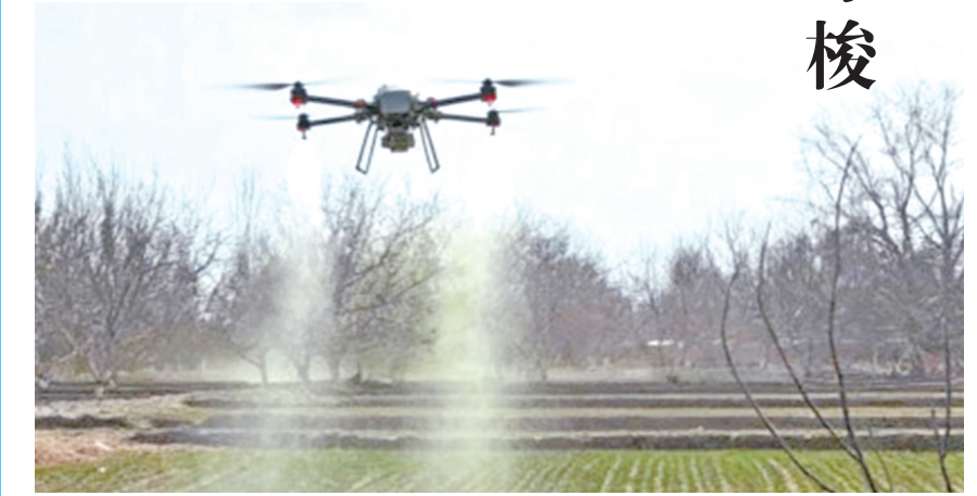
植保无人机沿着预设航线，将雾化后的农药均匀喷洒在小麦田间。地区融媒通讯员 常海亮 摄
