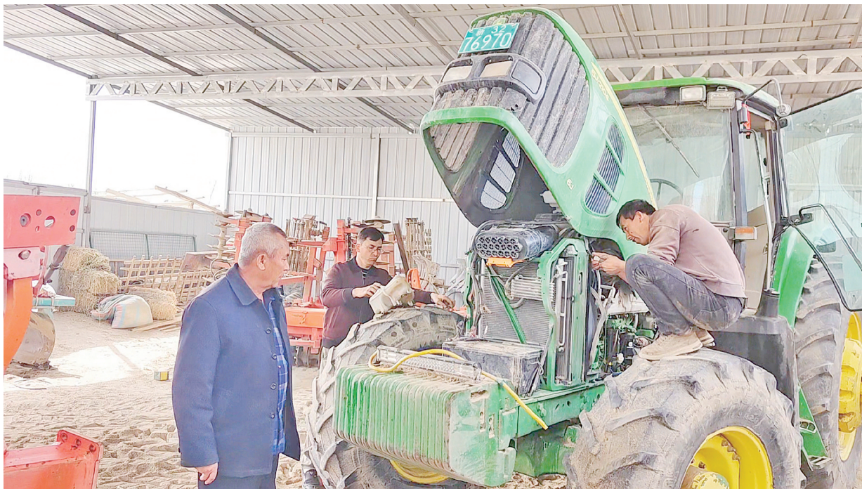
技术人员对大马力拖拉机进行全面检修保养。地区融媒通讯员 田秀文摄
